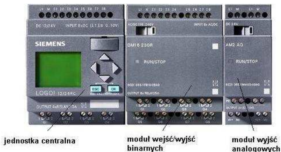
Rys. Budowa sterownika LOGO!
